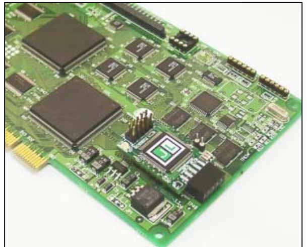
図 3 5PIN x 2 列 DIP モジュールとして実装
