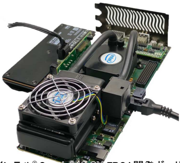
インテル® Stratix® 10 GX FPGA開発ボード + インテル® NVMe PCIe SSD での評価
