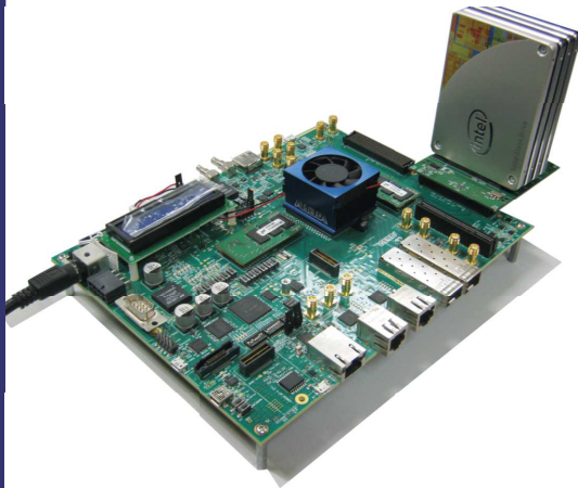
インテル®Arria® 10 SX FPGA開発ボード + DG製SATA-FMCアダプターボード (AB09-FMCRAID) + SATA-III SSD x 4ch RAID評価
