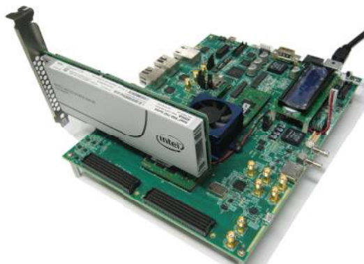
Arria 10 SX SoC FPGA開発ボード + Intel NVMe PCIe SSD での評価
