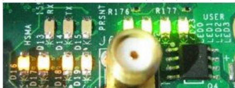
図 5: コンフィグレーション後の正常な LED 点灯状態
