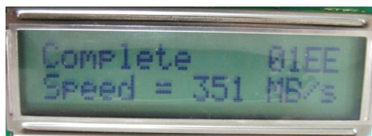
図 3-6: エラーがあった場合のコピー完了表示(CN1 は正常終了で CN2 と CN3 でエラー)
