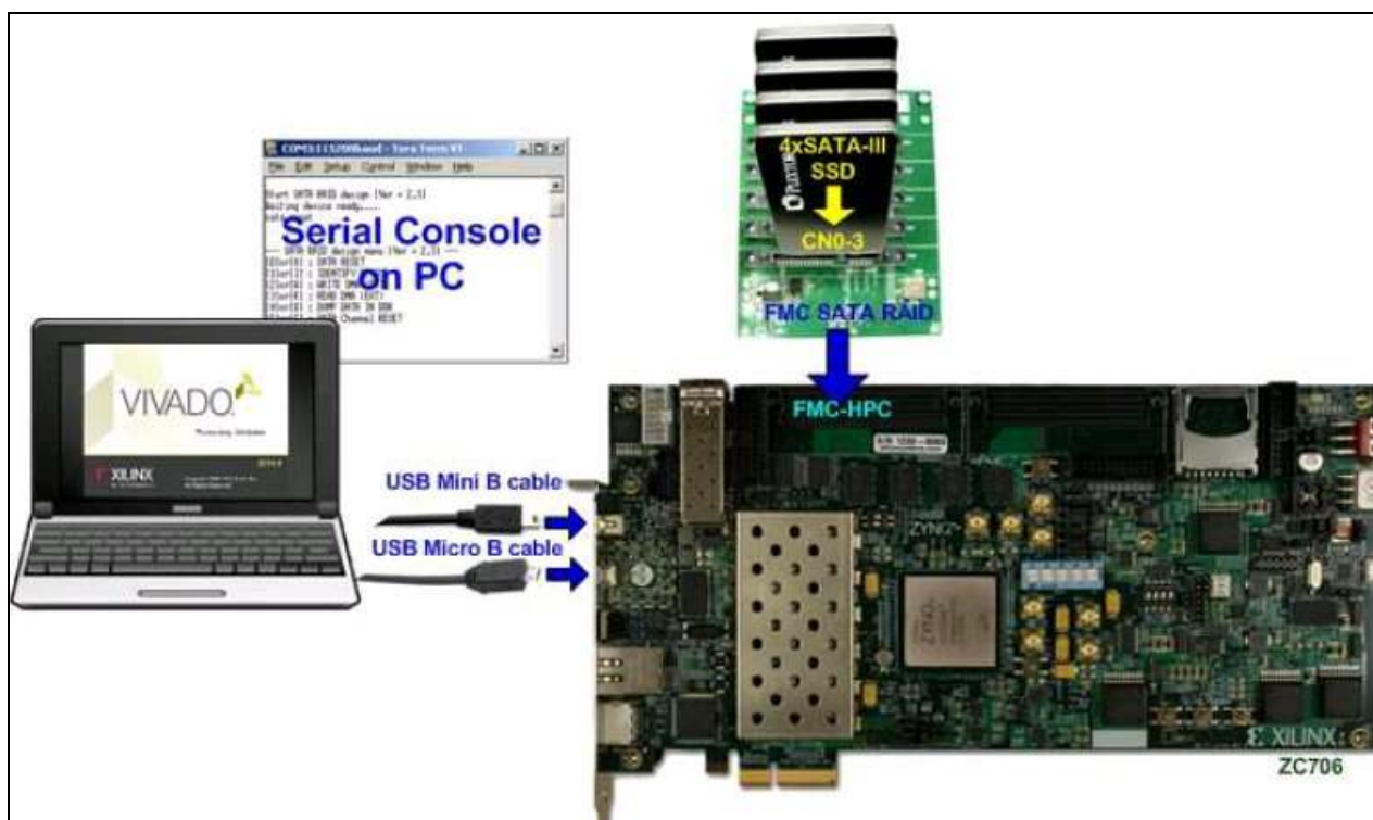
図 1-2: 4ch RAID デモ用ビット・ファイルによる ZC-706 実機評価環境
