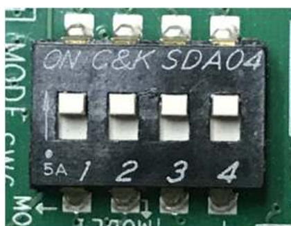
図 4-5: ZCU102 の SW6 を JTAG から PS コンフィグレーションに設定する
