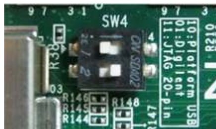
図 4-3: ZC706 の SW4 を USB-to-JTAG に設定する
