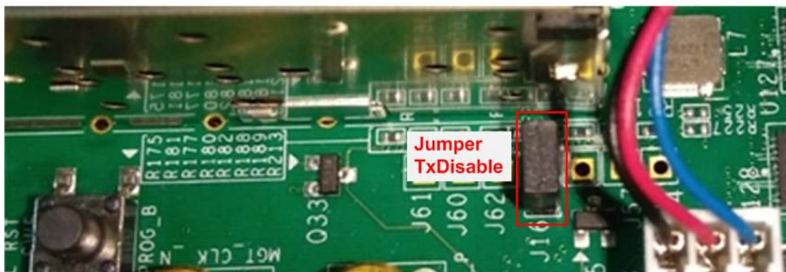
図 4-4: ZCU102 のジャンパを装着し SFP+をイネーブルとする
