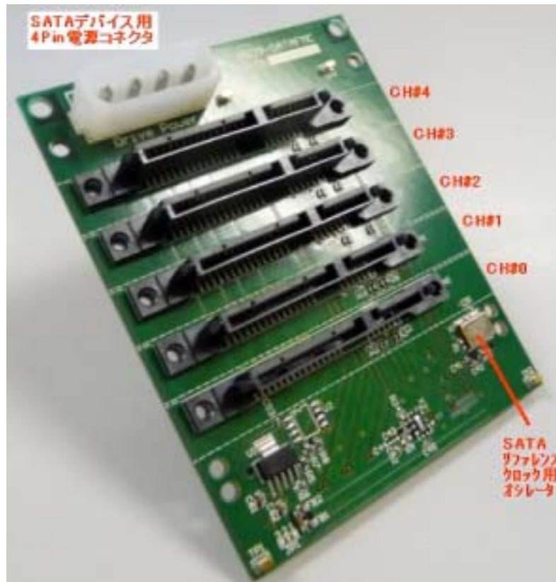
図 2: AB09-FMCRAID 基板の外観(部品面)
