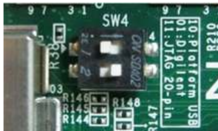
図 2-2: ZC706 ボードの場合 SW4 を USB からの JTAG にセットする
