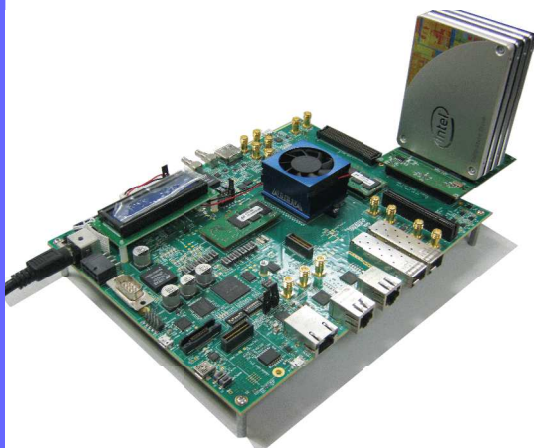
インテル®Arria® 10 SX FPGA開発ボード + DG製SATA-FMCアダプタボード (AB09-FMCRaid) + SATA-III SSD x 4ch RAID評価
