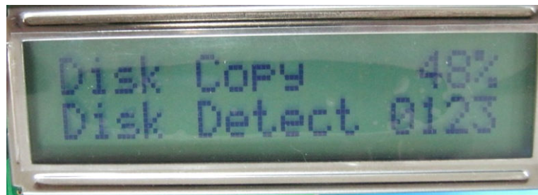
図 3-4: LCD によるコピー進捗状況の表示
