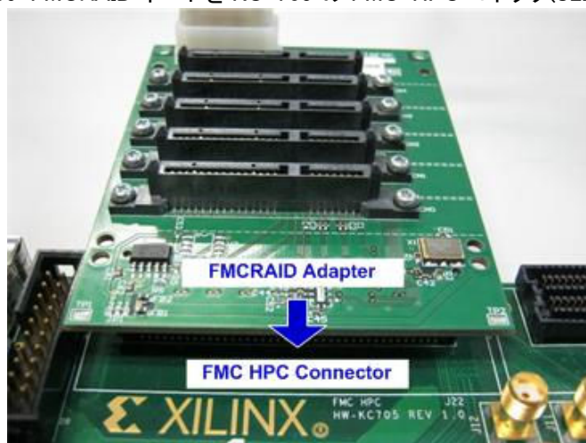
図 2-3: AB09-FMCRAID ボードを KC705 の FMC-HPC に接続
