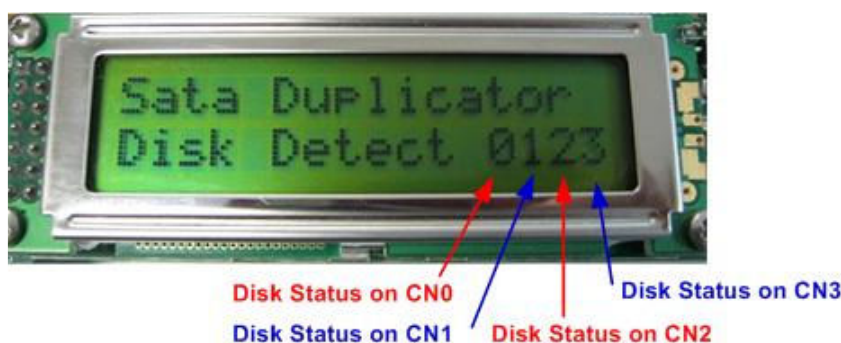
図 2-8: LCD 表示画面(CN0-3 全てに SATA-III ドライブが接続された状態)
