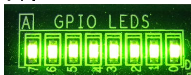
図 2-7: CN0-3 の全 4 コネクタに全て SATA-III デバイスが接続された場合の LED 状態
