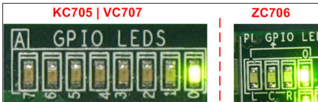
図 5: StartSW 押下後の LED0 点灯状態
