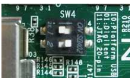
図 4: ZC706 の場合 SW4 で USB-JTAG 接続に設定する
