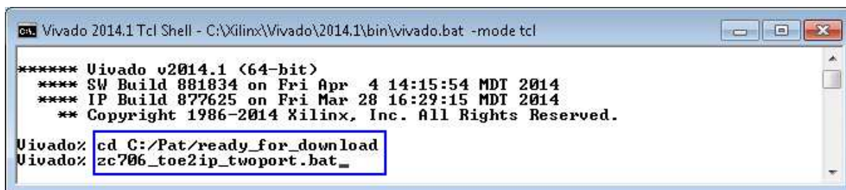
図 7: ZC706 での Vivado ツールによるダウンロード・スクリプト
