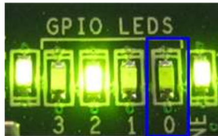
図 4-3: StartSW 押下後の IP コア初期化による LED0 の状態
